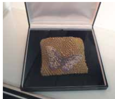
Pièce réalisée en une seule opération par frittage laser ou fusion de poudre métallique
